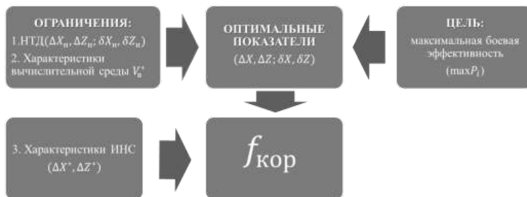
Рисунок 6 – Схема формирования требований к системе коррекции инерциальной навигационной системы (СК ИНС)
