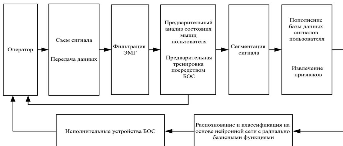
Рисунок 3 – схема распознавания мимических жестов на основе нейросетевого классификатора
