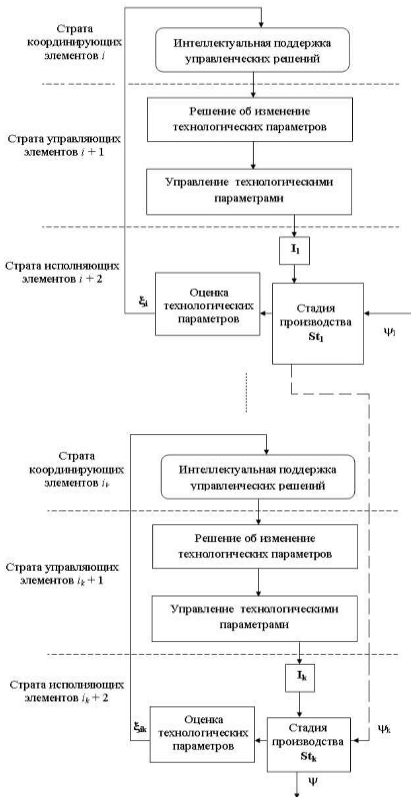
Рисунок 1 - Иерархическая структура сложной технологической многостадийной системы
