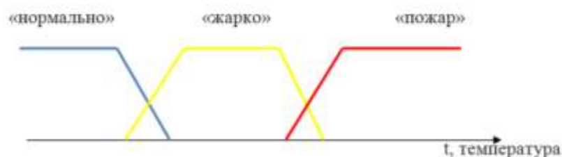
Рисунок 1. Переменные нечеткой логики в системе пожаротушения (температура)
