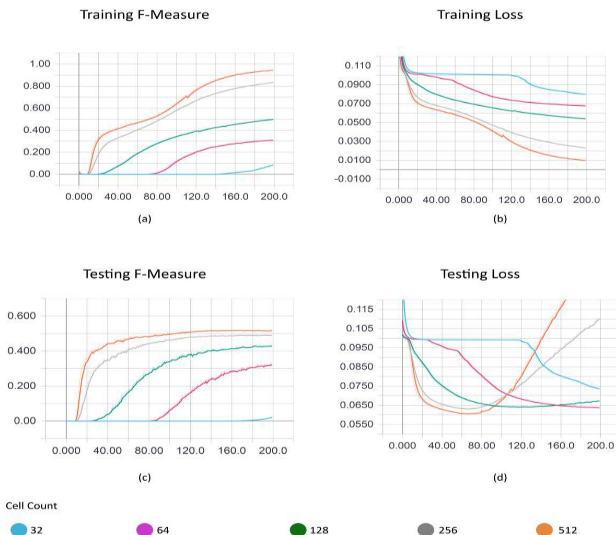
Рисунок 3 – Результаты эксперимента по тестированию размера слоев где а – тренировочная F-мера, b – тренировочное значение потерь, с – тестовая F-мера, d – тестовое значение потерь.
