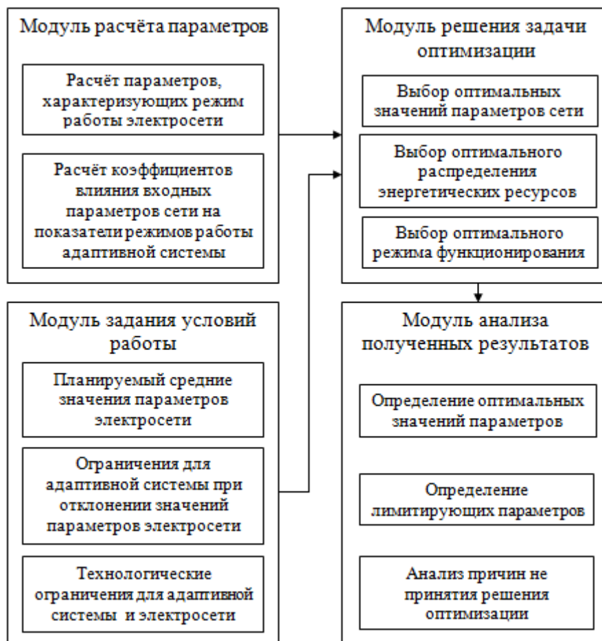
Рисунок 6 – Структура модели оптимизации адаптивной системы управления
