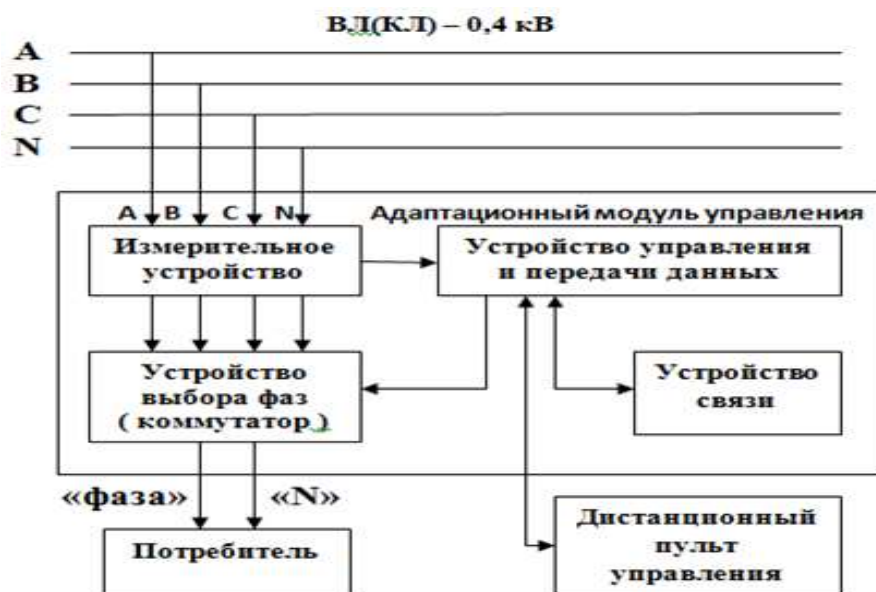
Рисунок 5 – Структурная схема адапционного модуля управления энергоснабжением потребителя
