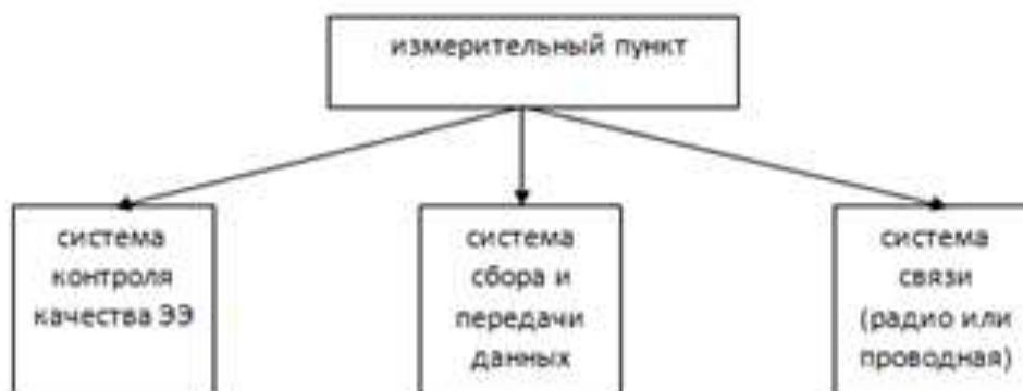
Рисунок 3 – Структурная схема управляющего измерительного комплекса 0,4(10) кВ
