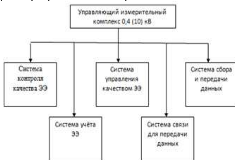
Рисунок 3 – Структурная схема управляющего измерительного комплекса 0,4(10) кВ
