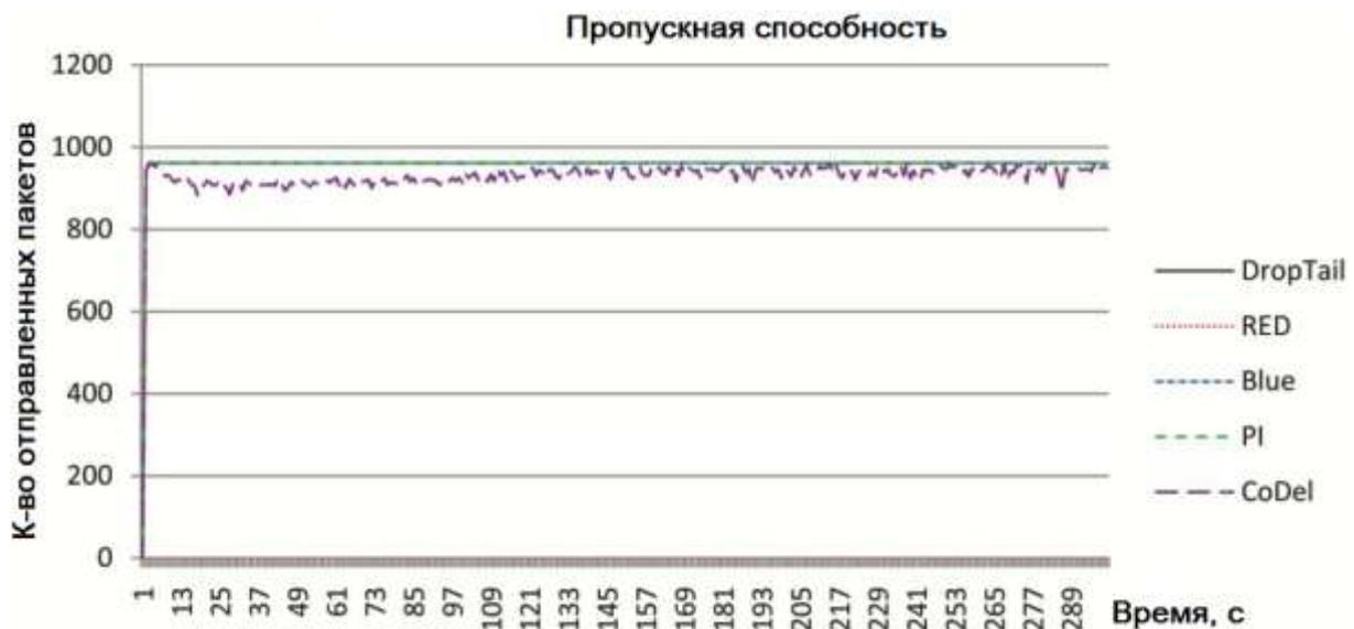
Рисунок 5 – Пропускная способность. 10 FTP-соединений
