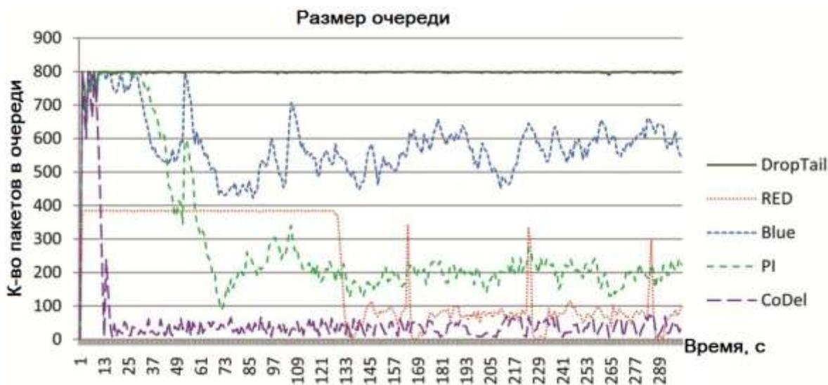
Рисунок 13 – Размер очереди. 100 FTP-соединений
