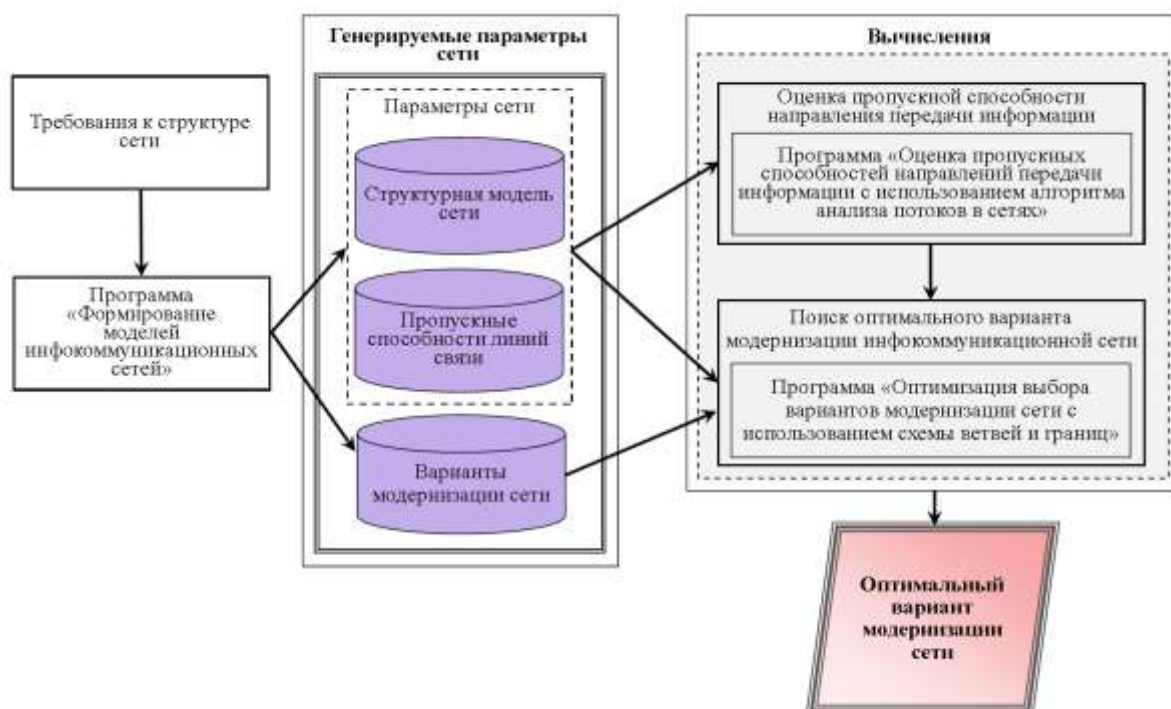
Рисунок 2 - Структурная схема работы программного комплекса в режиме имитационного моделирования для одного направления
