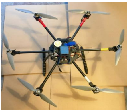
Рисунок 5 – Внешний вид типового воздушного объекта-носителя на базе гексакоптера Figure 5 – External appearance of a typical air carrier object based on a hexacopter
