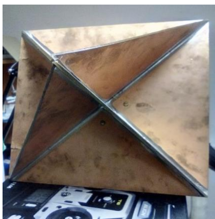
Рисунок 6 – Угловый радиолокационный отражатель Figure 6 – Corner radar reflector
