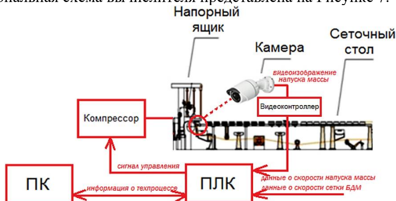
Рисунок 7 – Функциональная схема вычислителя Figure 7 – Functional diagram of the computer
