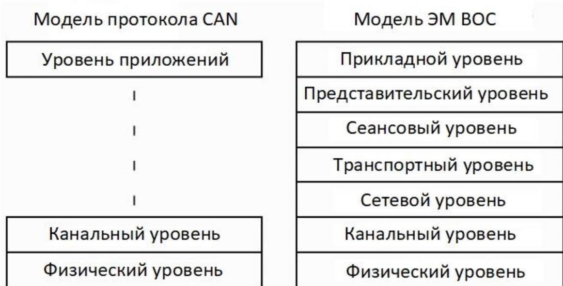
Рисунок 6 – Многоуровневая архитектура протокола CAN (стандарт 11898)
