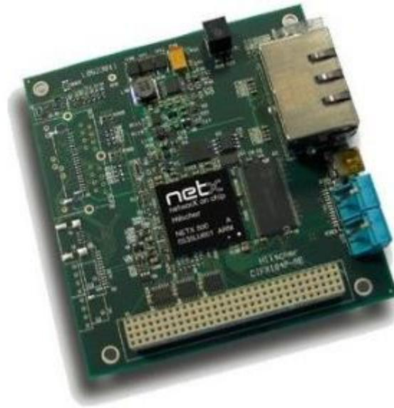
Рисунок 8 – Внешний вид контроллера CIFX 104C-RE-R Real-Time Ethernet Communication Card
