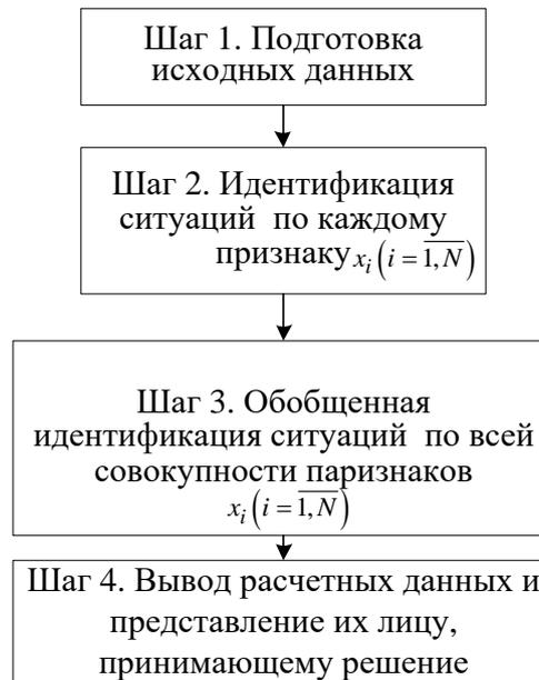
Рисунок 3 – Алгоритм идентификации ситуаций при управлении процессами обеспечения техногенной и пожарной безопасности по вероятностным признакам
