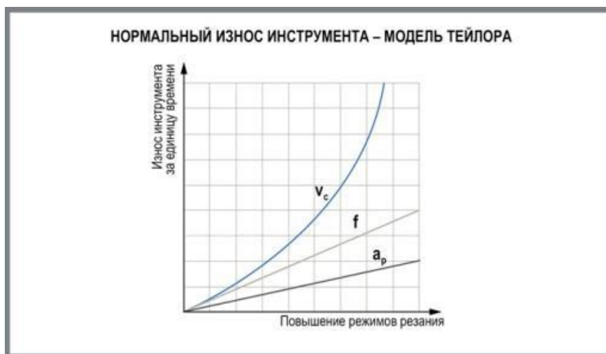
Рисунок 1 – Соотношение факторов, влияющих на износ режущего инструмента Figure 1 – Ratio of factors affecting the wear of the cutting tool
