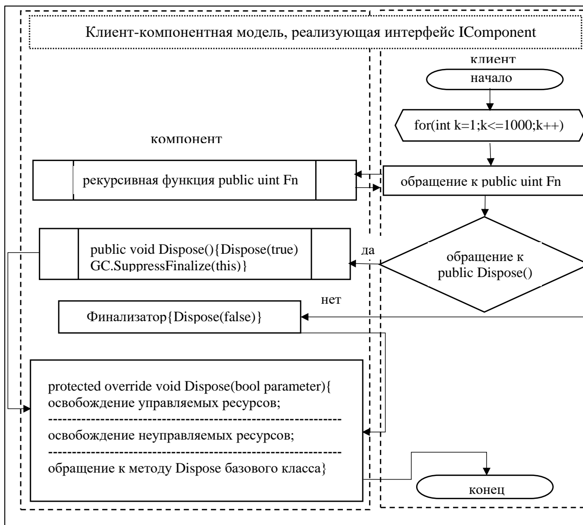
Рисунок 1 - Блок-схема Dispose-паттерна клиент-компонентной модели Figure 1 - Block diagram of the Dispose-pattern of the client-component model
