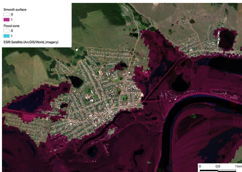
Рисунок 7 – Результат сравнения ЦМР с результатом радарного снимка Figure 7 – The result of comparing the DEM with the result of the radar image
