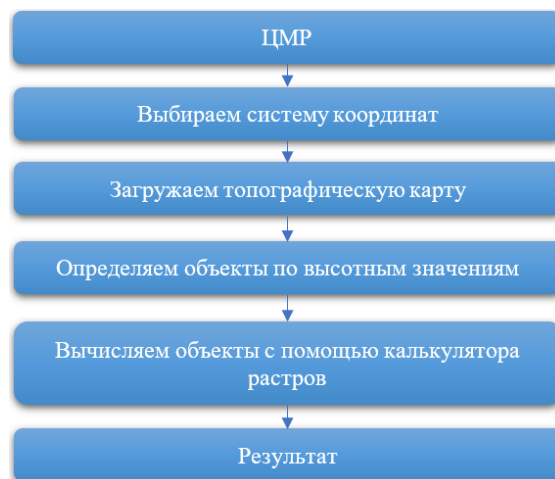
Рисунок 4 – Методология определения зон затопления для ЦМР Figure 4 – Methodology for determining flood zones for DTM
