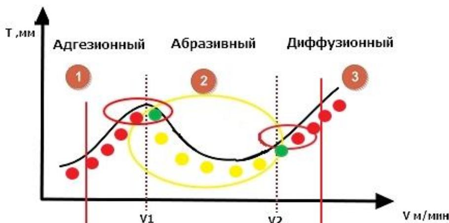
Рисунок 3 – Схема расчета износа инструмента на карте с учетом поправочных зон для твердосплавного инструмента
